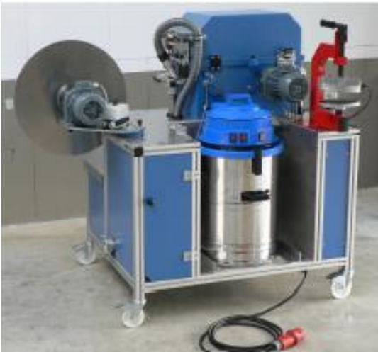
( Oproller in draaibare uitvoering voor gelijktijdig wassen en wikkelen of zijdelings naast de SPZ gezwenkt voor het enkelvoudig of half wikkelen van de slangen. Bediening via voetpedaalschakelaar ).
