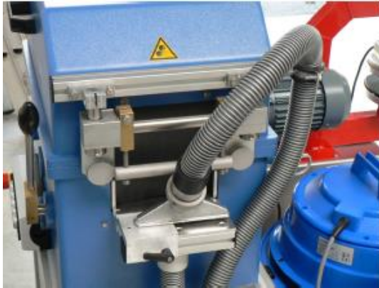
( Zwenkbare waterzuiger voor slangdroging )
